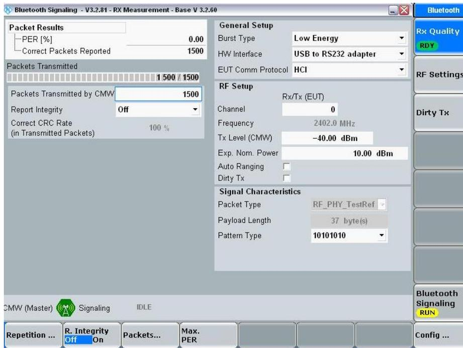
除了手动操作，还可以使用 CMWrun 自动测试软件对低功耗蓝牙进行测试（需 CMW-KT054 软件）。目前 CMWrun 的 1.8.0 正式版中已经提供了低功耗蓝牙的测试用例，用户可以很方便的编辑一个低功耗蓝牙测试脚本，如下所示。
