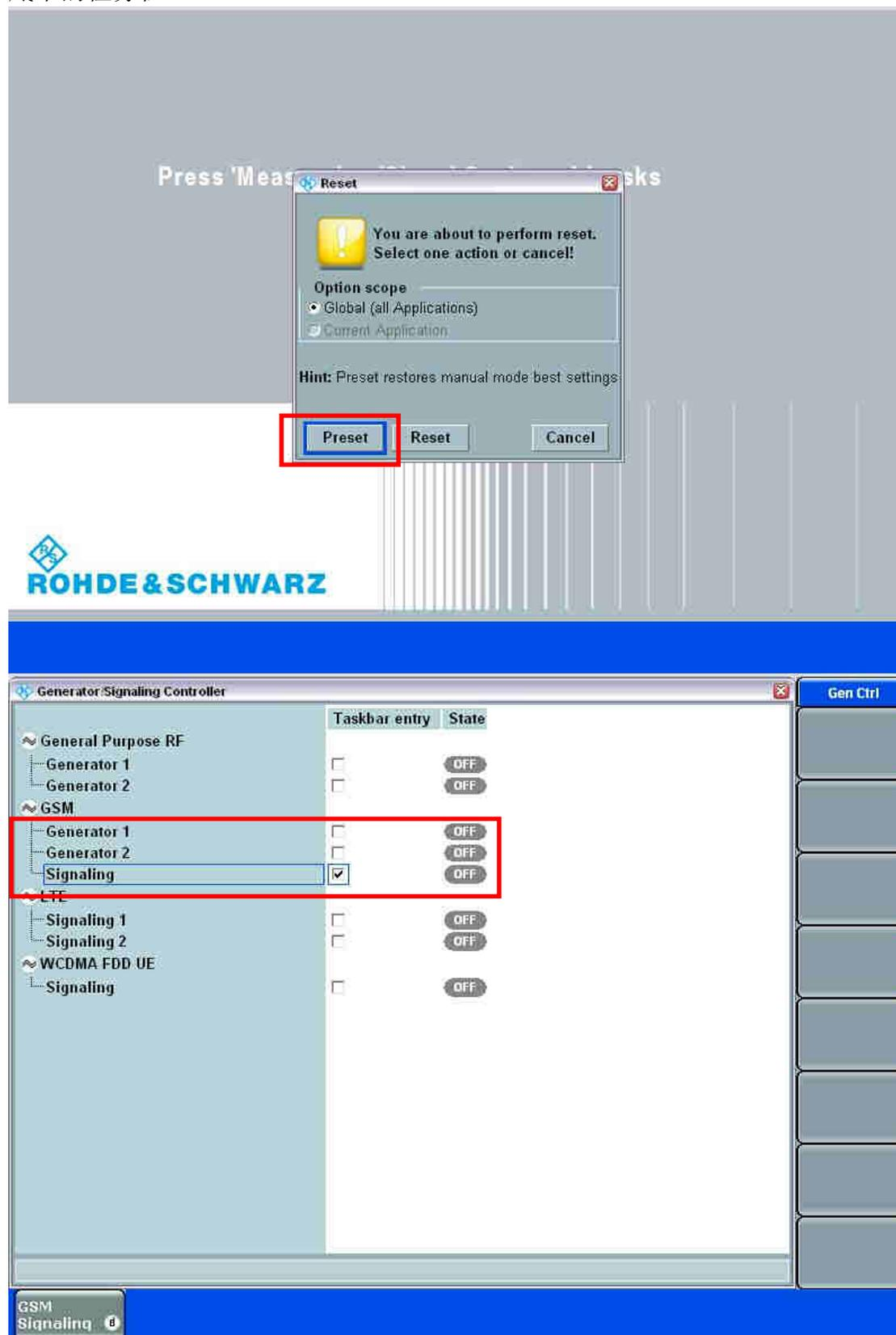
2. 按键：任务栏 GSM Signaling 下方对应的按键；用 On/Off 按钮打开小区。手机上电，注册。
