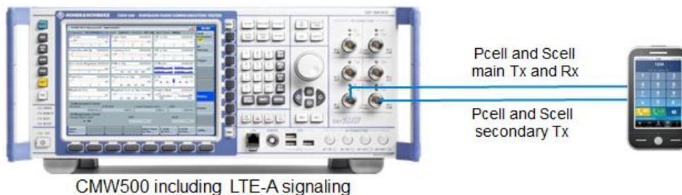
图1-1 单台CMW500的LTE-CA测试连接图
